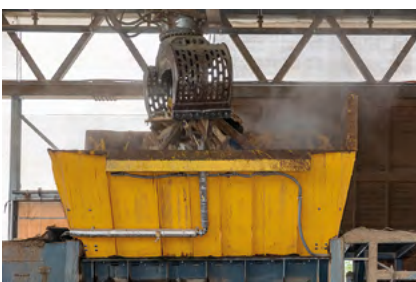
Direkt am Shredder sind Düsen integriert.
