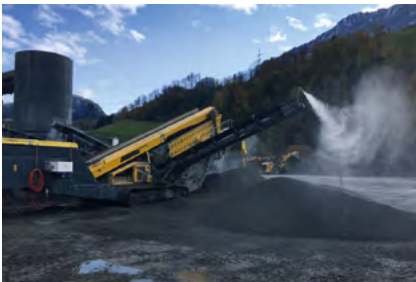
Düsen befeuchten die Abwurfstellen.
