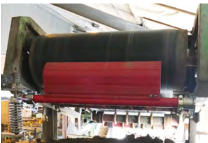
Ein Abstreifer reinigt das Band zusätzlich.
