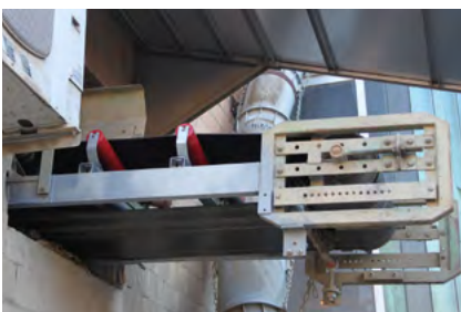
Die Zusatzkonstruktion verlängert das Band.
